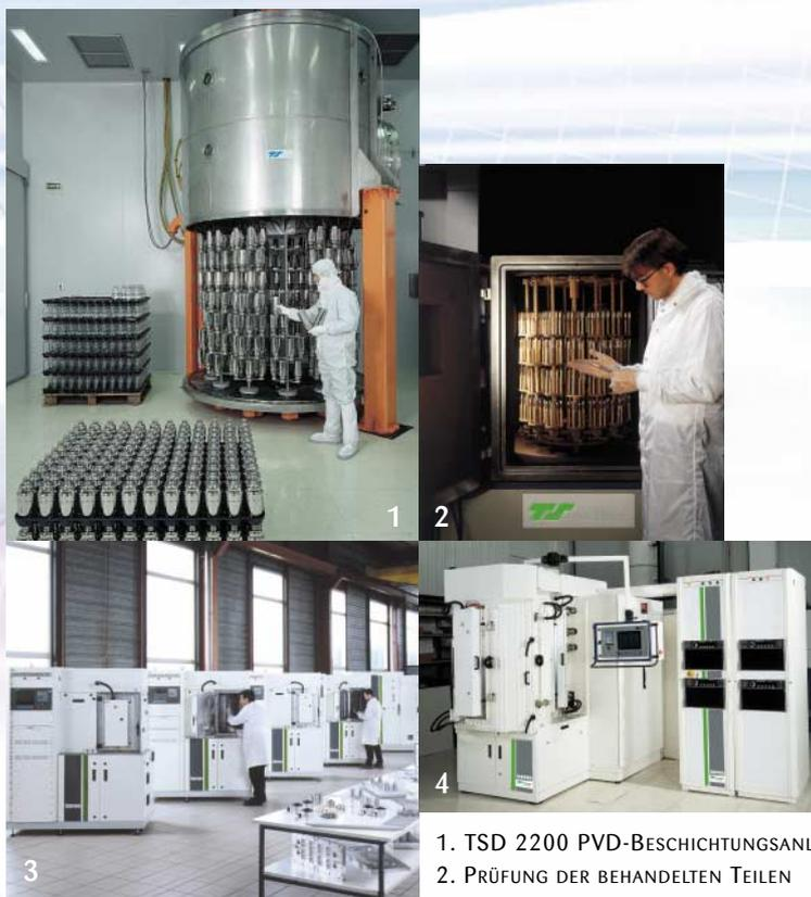
1. TSD 2200 PVD-BESCHICHTUNGSANLAGE
